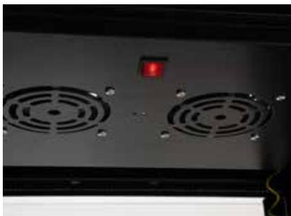
Für eine zuverlässige Kühlung ist ein **integrierter Lüfter** verbaut, der die entstehende Wärme effektiv ableitet.
