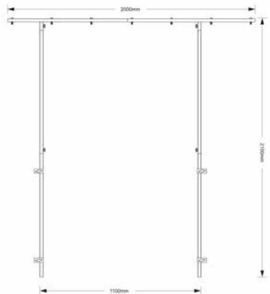
Maximale Last: Verteilt 6x5 kg
