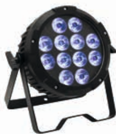
FUTURELIGHT PRO Slim PAR-12 MK2 HCL Flacher PRO-LED-Scheinwerfer mit 12 x 10-W-6in1-LED (RGBWA+UV) ohne Lüfter
