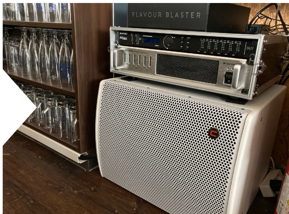
OMNITRONIC MCD-3006 6-Kanal-Endstufe 6-Kanal-PA-Verstärker mit Schaltnetzteil, 4 Ohm: 6 x 500 W, 8 Ohm: 6 x 250 W
