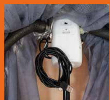
Batteriebox mit Auslöser und USB-Stromanschluss
