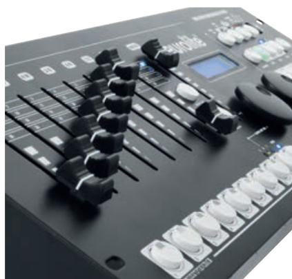
Alle acht DMX-Kanalfader sind motorisiert ausgeführt
