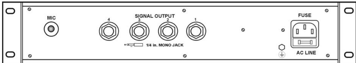
Connecter votre stroboscope (jusqu'à 5 strobos) à la douille de Jack utilisant un câble d'instrument ( $1 \times 0,22$  avec blindage).
