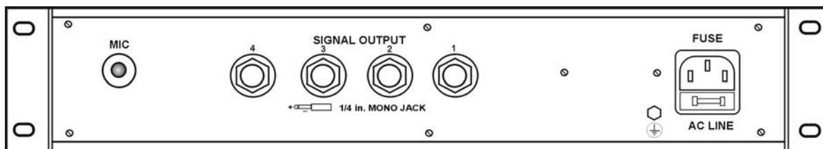
An die Mono-Klinkenbuchsen können Sie über eine Instrumentenleitung ( $1 \times 0,22 \text{ mm}^2$  mit Abschirmung) Ihr(e) Stroboskop(e) (bis zu 5 Stück) anschließen.
