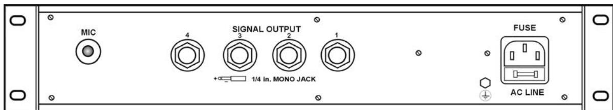
Vd. puede conectar hasta 5 strobes al casquillo jack mono mediante un cable de instrumentos (1 x 0,22 con shield).
