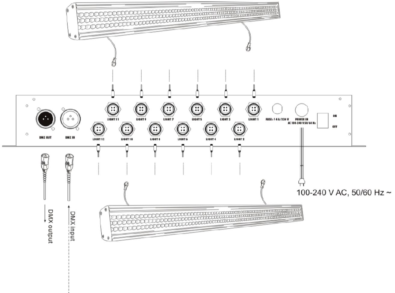
Schließen Sie Ihren LED Bar an eines der 4-poligen Verbindungskabel des Controllers an. An jeden der 12 Ausgänge des LED PSI-1 DMX Contollers kann jeweils eine LED Bar angeschlossen werden.
