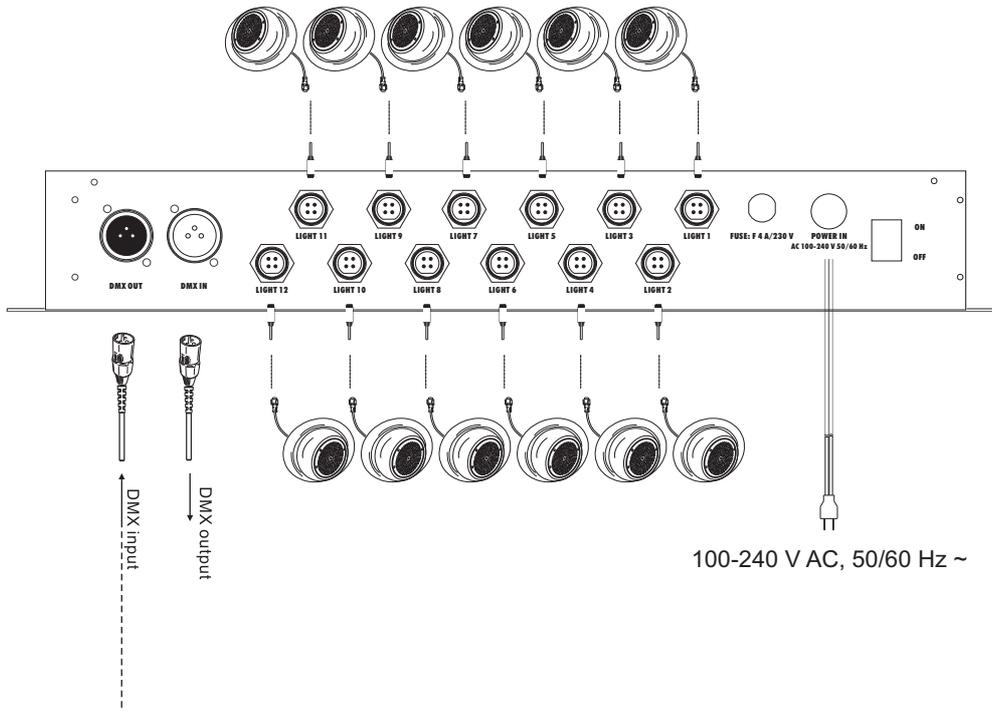
Schließen Sie Ihre Leuchte an eines der 4-poligen Verbindungskabel des Controllers an.
