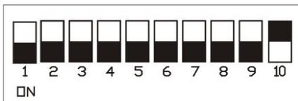
Stellen Sie DIP Schalter 10 auf ON um das Slave Gerät festzulegen. Dip Schalter 1 – 9 sind auf OFF.
