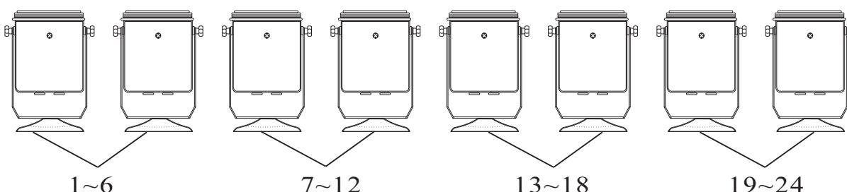
**ndl8****Steuerkanal 4 – Jeder Spot belegt 6 Kanäle. Acht Spots belegen 48 Kanäle.**
