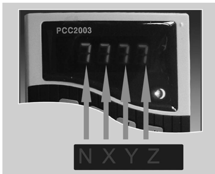
**N, X, Y, Z** sont les quatre places au display avec „canaux“ à 0 de 9.
