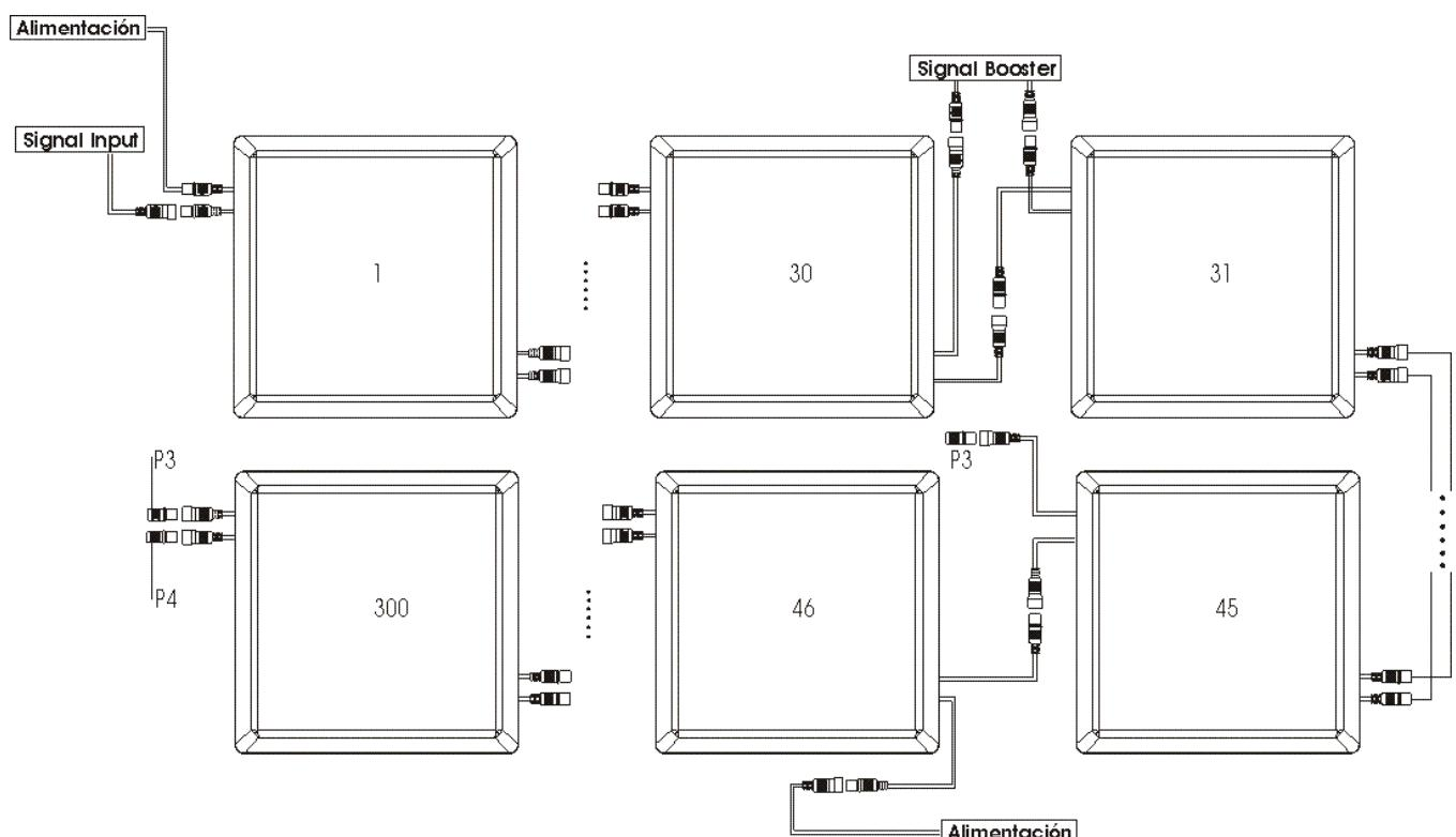
**Atención:** Después de 15 paneles LED 60 x 60 cm o 30 paneles 60 x 30 cm debe instalar uno booster para enfocar las señales.
