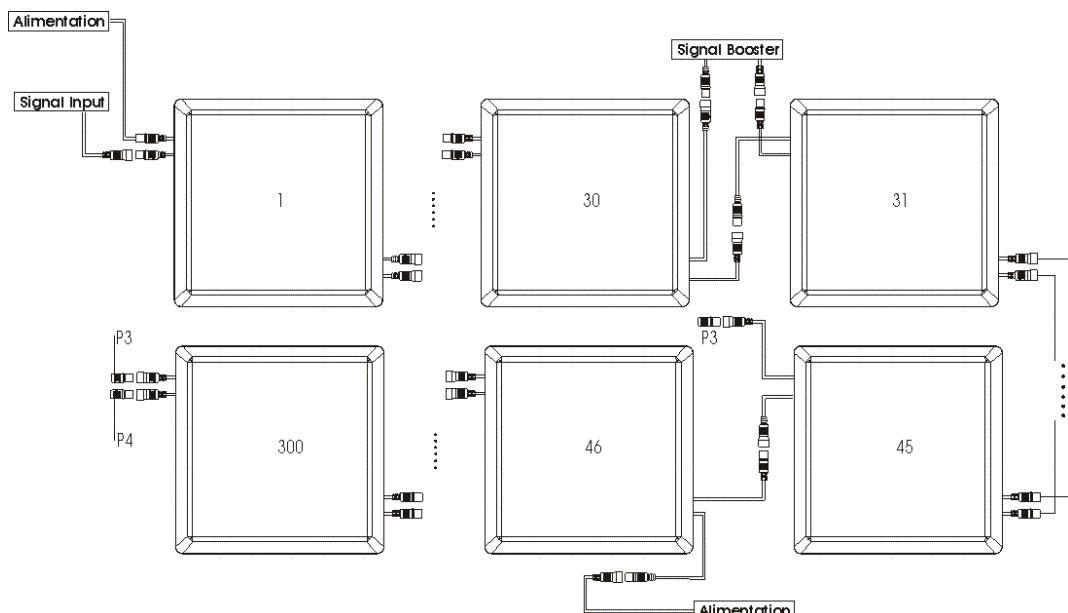
**Attention:** Apres chaque groupe de 15 panneaux DEL 60 x 60cm, ou de 30 panneaux DEL 60 x 30cm, on doit installer un booster pour le renforcement de signal.
