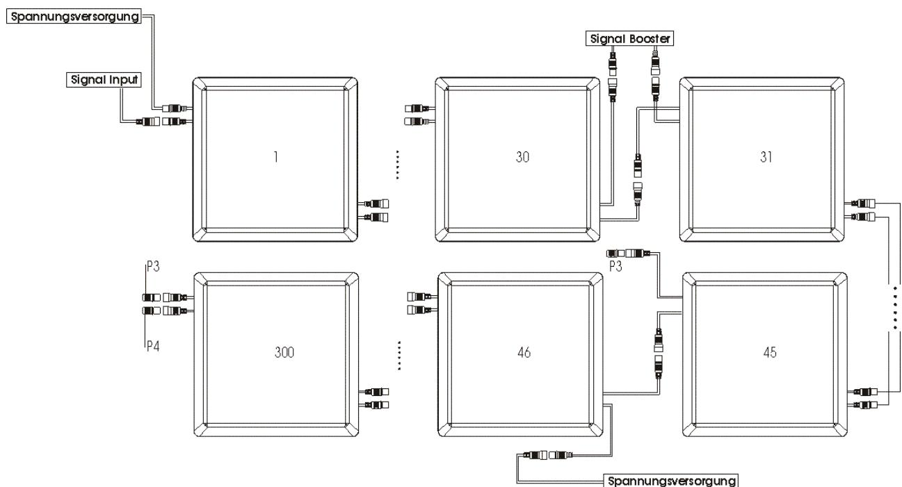
P3 = 2-polige Spannungsversorgungsleitungsbuchse
