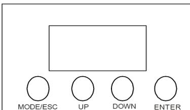
Durch Drücken der MODE/ESC-Taste können Sie sich im Hauptmenü bewegen. Durch Drücken der UP/DOWN-Taste können Sie die Auswahl verändern. Bestätigen Sie jede Änderung durch Drücken der ENTER-Taste. Der jeweilige Modus kann durch die MODE/ESC-Taste verlassen werden. Die jeweiligen Funktionen werden im Folgenden aufgeführt.
