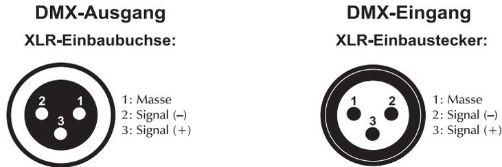
Wenn Sie Controller mit dieser XLR-Belegung verwenden, können Sie den DMX-Ausgang des Controllers direkt mit dem DMX-Eingang des ersten Gerätes der DMX-Kette verbinden. Sollen DMX-Controller mit anderen XLR-Ausgängen angeschlossen werden, müssen Adapterkabel verwendet werden.
