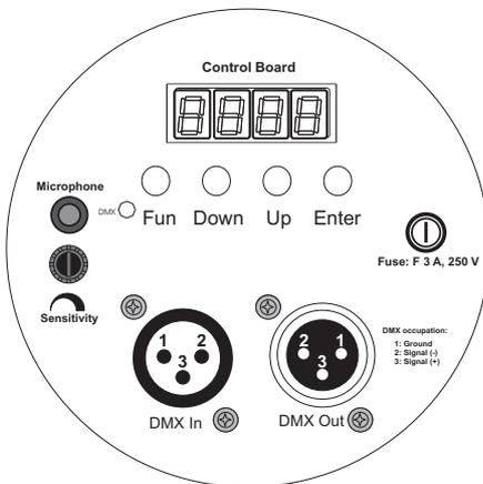
Über die FUN-Taste gelangen Sie ins Menü. Durch Drücken der UP- oder DOWN-Tasten können Sie die Auswahl verändern. Bestätigen Sie jede Änderung durch Drücken der ENTER-Taste. Der jeweilige Modus kann durch die FUN-Taste verlassen werden. Die jeweiligen Funktionen werden im Folgenden beschrieben.
