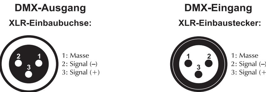
Wenn Sie Controller mit dieser XLR-Belegung verwenden, können Sie den DMX-Ausgang des Controllers direkt mit dem DMX-Eingang des ersten Gerätes der DMX-Kette verbinden. Sollen DMX-Controller mit anderen XLR-Ausgängen angeschlossen werden, müssen Adapterkabel verwendet werden.
