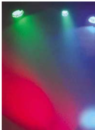
Farbverschiebungen wie bei Flood-Boxen mit dichroitischen Filtern gibt es bei LEDs nicht.
