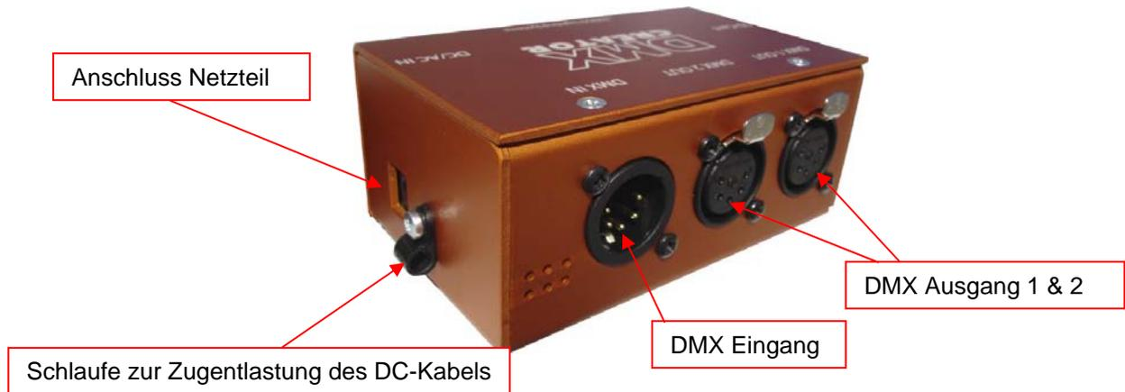
Ihre DMX512-fähigen Geräte können Sie direkt an das Hardware Interface anschließen. Bitte verwenden Sie nur Kabel welches für die Übertragung von DMX512 Daten geeignet ist (Kein standard Mikrofonkabel!). Schließen Sie jeden Datenstrang mit einem 120Ohm Abschlusswiderstand ab (Am DMX-Ausgang des letzten Gerätes in der Leitung).
