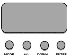
Durch Drücken der Mode-Taste können Sie sich im Hauptmenü bewegen. Zur Auswahl des gewünschten Menüpunktes drücken Sie die Enter-Taste. Durch Drücken der Up/Down-Taste können Sie die Auswahl verändern. Bestätigen Sie jede Änderung durch Drücken der Enter-Taste. Der jeweilige Modus kann durch die Mode-Taste verlassen werden. Die jeweiligen Funktionen werden im Folgenden aufgeführt.
