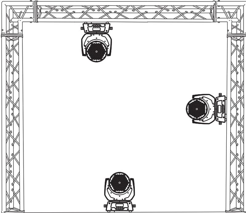
Das Gerät kann direkt auf den Boden gestellt werden oder in jeder möglichen Position im Trussing installiert werden, ohne seine funktionellen Eigenschaften zu verändern.
