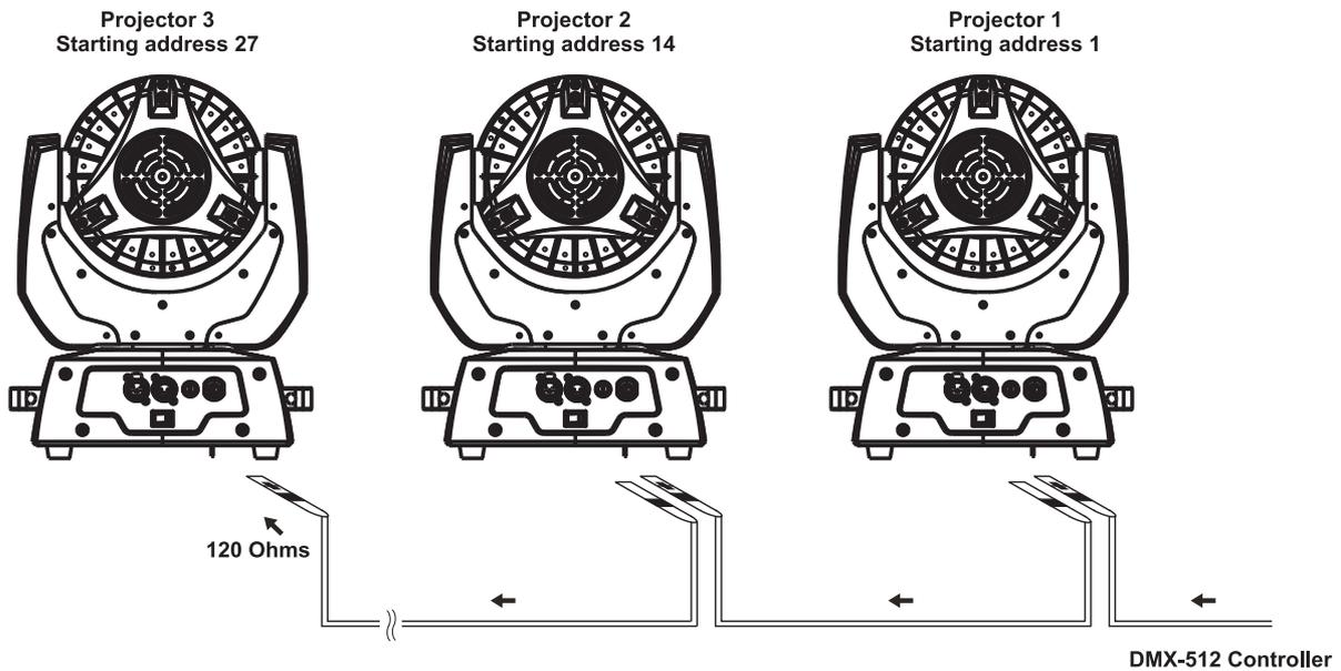
**Achten Sie darauf, dass die Adern der Datenleitung an keiner Stelle miteinander in Kontakt treten. Die Geräte werden ansonsten nicht bzw. nicht korrekt funktionieren.**
