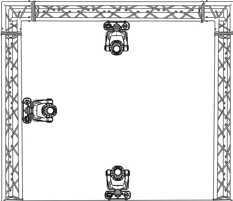
El aparato puede ser colocado directamente en el suelo o puede ser instalado en cualquier posición en el trussing sin alterar sus características operativas.
