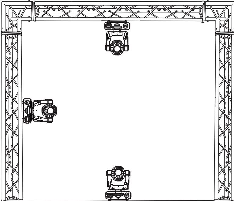
L'appareil peut être mis directement au sol ou être installé dans chaque position possible dans le Trussing, sans changer ses caractéristiques fonctionnelles.
