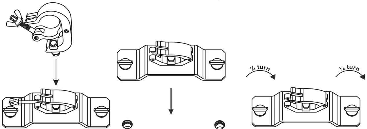
Verschrauben Sie je einen Haken über eine M12 Schraube und Mutter mit den Omega-Haltern.
