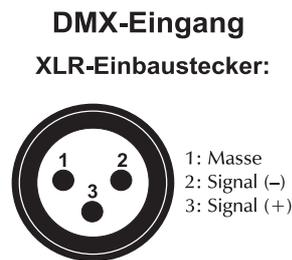
Wenn Sie Controller mit dieser XLR-Belegung verwenden, können Sie den DMX-Ausgang des Controllers direkt mit dem DMX-Eingang des ersten Gerätes der DMX-Kette verbinden. Sollen DMX-Controller mit anderen XLR-Ausgängen angeschlossen werden, müssen Adapterkabel verwendet werden.
