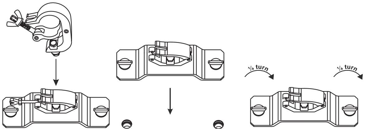
Atornille el agrafe con un tornillo M12 con los soportes Omega.
