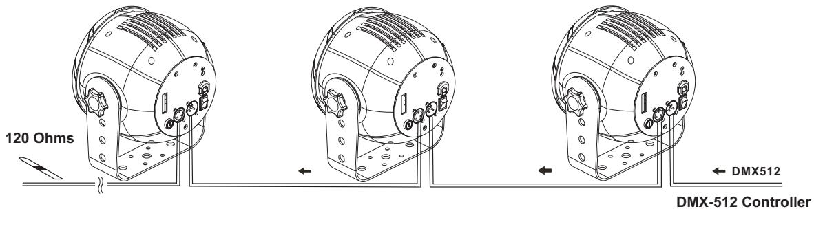
**Achten Sie darauf, dass die Adern der Datenleitung an keiner Stelle miteinander in Kontakt treten. Die Geräte werden ansonsten nicht bzw. nicht korrekt funktionieren.**
