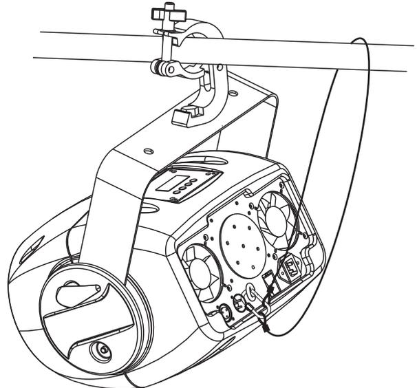
Insere el cable de anclaje en el ojete de seguridad y en el trussing u un lugar de fijación seguro. Insere el final en el eslabón de conexión roscado y fije el tornillo de seguridad.
