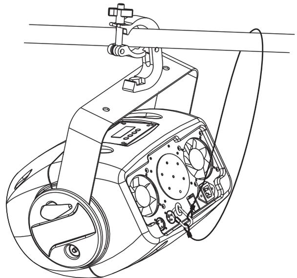
Accrochez l'élingue de sécurité dans l'oeillet de sécurité et le trussing ou un point de fixation stable. Accrochez le fin au maillon de connection fileté et serrez bien la vis de sécurité.
