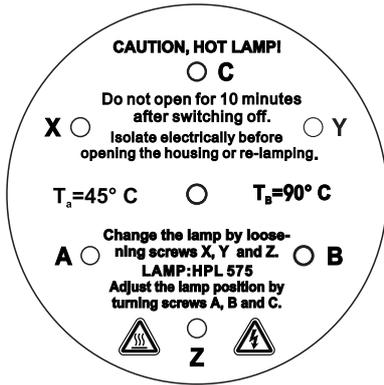
Der Lampenhalter des Gerätes wird ab Werk justiert. Da sich die zu verwendenden Lampen von Hersteller zu Hersteller unterscheiden, kann es u. U. notwendig sein, die Position des Lampenhalters nachzujustieren.
