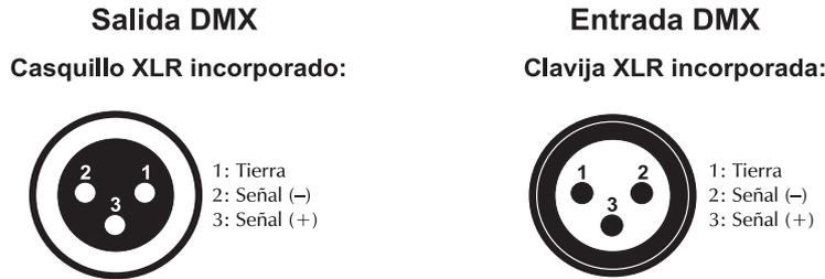
Cuando Vd. utilice los controladores con la ocupación descrita, puede conectar la salida DMX del controlador directamente con la entrada DMX del primer aparato de la cadena DMX. Cuando Vd. quiere conectar controladores DMX con otras salidas DMX, se tiene que utilizar cables de adaptación.
