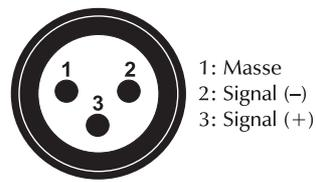
Quand vous utilisez un contrôleur avec cette occupation, vous pouvez directement connecter la sortie DMX du contrôleur avec l'entrée DMX du premier appareil de la chaîne DMX. Quand vous voulez connecter des contrôleurs DMX avec des sorties DMX différentes, il est nécessaire d'utiliser des câbles d'adaptation.
