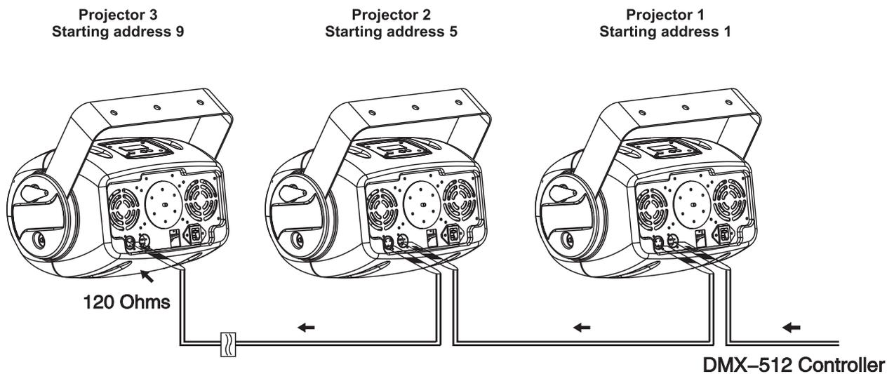
**⚠ Asegúrese de que los conductores del cable de datos no hagan contacto entre sí. Los aparatos no van a funcionar o no van a funcionar correctamente. ⚠**
