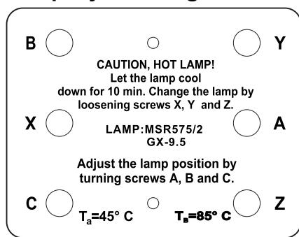
Der Lampenhalter des Gerätes wird ab Werk justiert. Da sich die zu verwendenden Lampen von Hersteller zu Hersteller unterscheiden, kann es u. U. notwendig sein, die Position des Lampenhalters nachzustellen.
