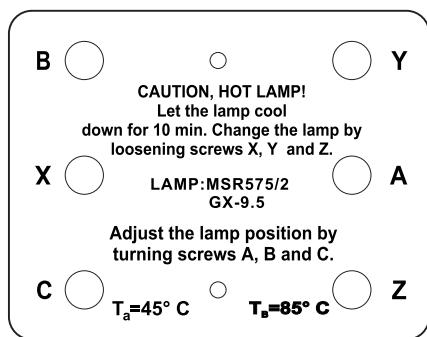
El sistema de portalámparas está ajustado en la fábrica. Como las lámparas de los fabricantes diferentes son diferentes, puede ser necesario de reajustar la posición del sistema de portalámparas.
