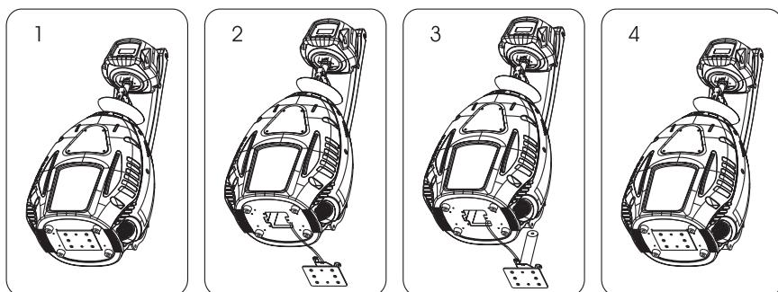
**Schritt 1:** Lösen Sie die Befestigungsschrauben X, Y, Z des Lampensystems und entnehmen Sie dieses vorsichtig aus dem Gehäuse.
