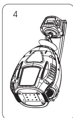
**Paso 1:** Desatornille los tornillos de fijación X, Y, Z del sistema de lámpara y quitelo.
