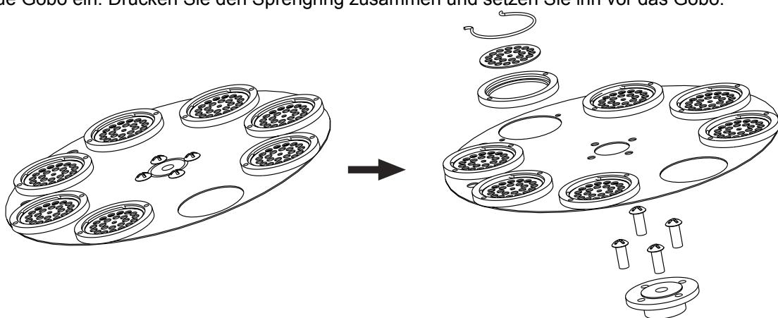
Bitte achten Sie beim Einsetzen von Metallgobos darauf, dass die spiegelverkehrte Seite zur Lampe hin zeigt. Wenn Sie Glasgobos einsetzen, achten Sie bitte darauf, dass die beschichtete Seite von der Lampe weg zeigt.
