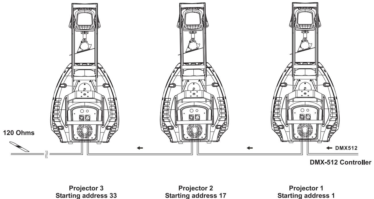
**Achten Sie darauf, dass die Adern der Datenleitung an keiner Stelle miteinander in Kontakt treten. Die Geräte werden ansonsten nicht bzw. nicht korrekt funktionieren.**
