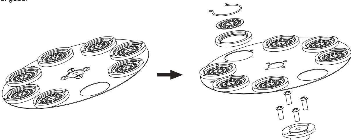
Cuando instalar gobos de metal asegúrese de que el lado invertido está direccionado a la lámpara. Cuando instalar gobos de vidrio asegúrese de que el lado recubierto fuera de la lámpara.
