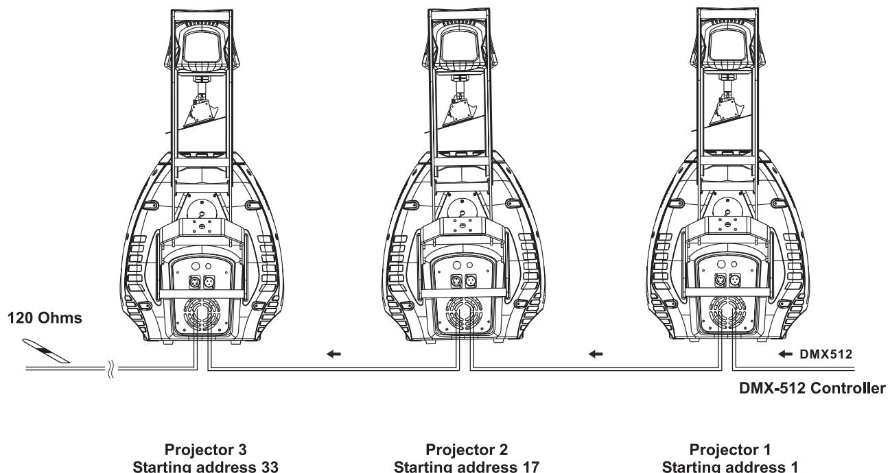
**Asegúrese de que los conductores del cable de datos no hagan contacto entre si. Los aparatos no van a funcionar o no van a funcionar correctamente.**
