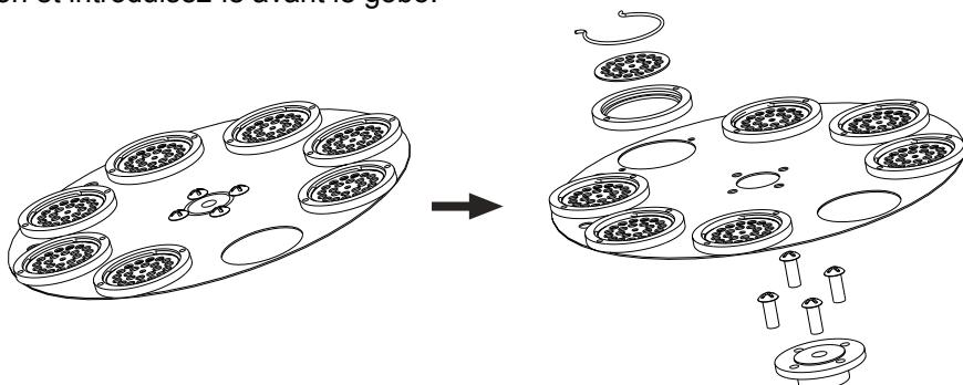
Quand installer des gobos métalliques, assurez-vous que la côté inversée montre en direction de la lampe. Quand installer des gobos en verre, assurez-vous que la côté couchée montre partie de la lampe.
