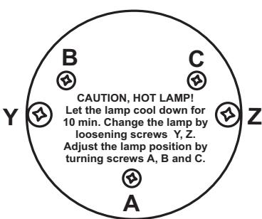
Der Lampenhalter des Gerätes wird ab Werk justiert. Da sich die zu verwendenden Lampen von Hersteller zu Hersteller unterscheiden, kann es u. U. notwendig sein, die Position des Lampenhalters nachzusteuern.
