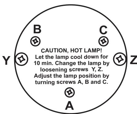
El sistema de portalámparas está ajustado en la fábrica. Como las lámparas de los fabricantes diferentes son diferentes, puede ser necesario de reajustar la posición del sistema de portalámparas.
