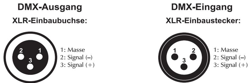
Wenn Sie DMX-Controller mit dieser XLR-Belegung verwenden, können Sie den DMX-Ausgang des Controllers direkt mit dem DMX-Eingang des ersten Geräts der DMX-Kette verbinden. Sollen DMX-Controller mit anderen XLR-Ausgängen angeschlossen werden, müssen Adapterkabel verwendet werden.
