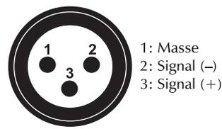
Wenn Sie Controller mit dieser XLR-Belegung verwenden, können Sie den DMX-Ausgang des Controllers direkt mit dem DMX-Eingang des ersten Gerätes der DMX-Kette verbinden. Sollen DMX-Controller mit anderen XLR-Ausgängen angeschlossen werden, müssen Adapterkabel verwendet werden.
