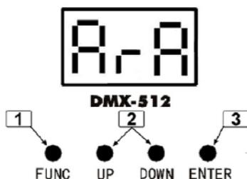
Wenn Sie MODE OPTION aufrufen, blinkt die aktuelle Lasershow. Drücken Sie die UP oder DOWN Tasten, um die Lasershow zu ändern. Es stehen acht verschiedene vorprogrammierte Stand Alone Lasershows zur Auswahl:
