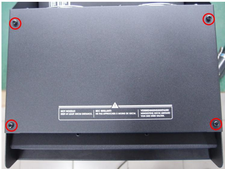
**Schritt 1. Lösen Sie die Schrauben an der Seite.**
