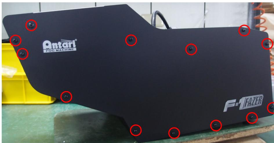
**Schritt 2. Lösen Sie die Schrauben an der Rückseite.**
