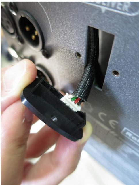
Schritt 3: Verbinden Sie die Klemmen mit dem W-1 Funkempfänger.
