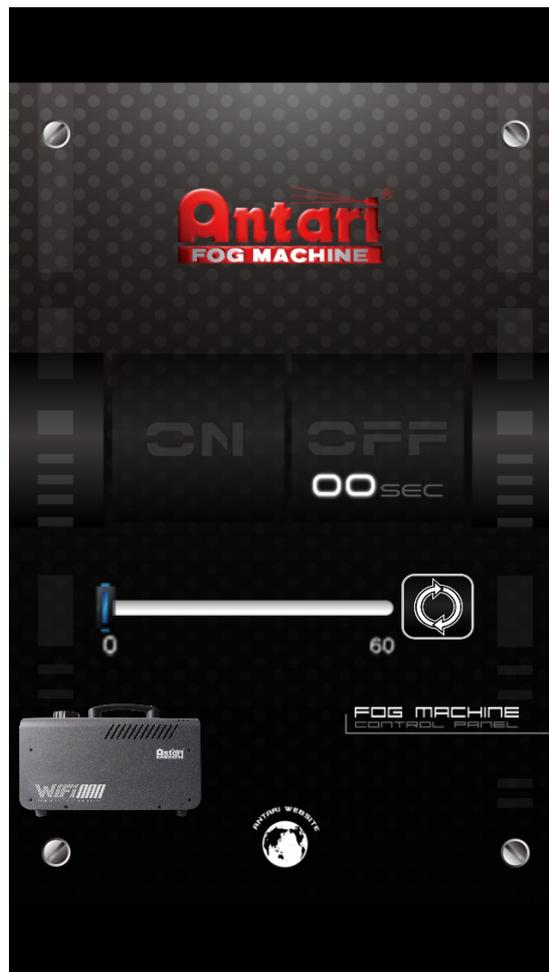
**Timer-Betrieb:** Bestimmen Sie eine Zeit für die Nebeldauer zwischen 1 und 60 Sekunden. Verstellen Sie dazu Leiste und drücken Sie ON, um den Nebelausstoß auszulösen. Wenn der Timer auf 0 Sekunden zurückgezählt hat, wird der Nebelausstoß wieder eingestellt.
