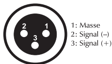
DMX-Ausgang XLR-Einbaubuchse:
