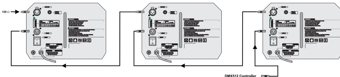
Die Verbindung zwischen Controller und Gerät sowie zwischen den einzelnen Geräten sollte mit einem DMX-Kabel erfolgen. Als DMX-Schnittstelle besitzt das Gerät 3-polige XLR-Stecker und -Kupplungen. Bei Verwendung von Geräten mit anderen XLR-Anschlüssen, müssen Adapterkabel verwendet werden.
