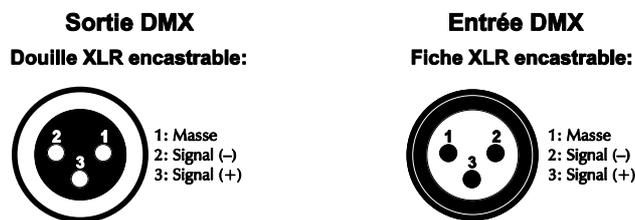
Quand vous utilisez un contrôleur avec cette occupation, vous pouvez directement connecter la sortie DMX du contrôleur avec l'entrée DMX du premier appareil de la chaîne DMX. Quand vous voulez connecter des contrôleurs DMX avec des sorties DMX différentes, il est nécessaire d'utiliser des câbles d'adaptation.
