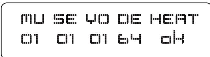
Après un temps de chauffage, la machine est prête à l'utilisation. L'indication "Ok" apparaît alors sur l'affichage. Appuyer sur le bouton Output de la télécommande pour activer le débit de fumée. Pendant l'utilisation, le liquide refroidit la résistance. Après un certain laps de temps, la machine s'arrêtera de fonctionner pendant 1 à 2 minutes pour que la résistance réchauffe. Ceci est nécessaire pour obtenir une température constante. La température est régulée électroniquement.
