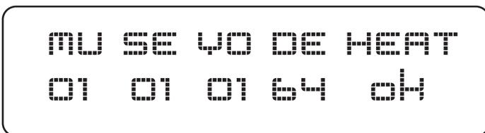
Nach einer bestimmten Heizphase ist das Gerät nebelbereit. Auf dem Display der Fernsteuerung erscheint „ok“ unter der Funktionsanzeige HEAT. Durch Betätigen der Output-Taste auf der Fernsteuerung wird der Nebelausstoß hervorgerufen. Während des Betriebes kann es vorkommen, dass die Anzeige unter HEAT
