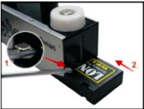
1. Platte vor dem Einsetzen des Akkus anheben.
