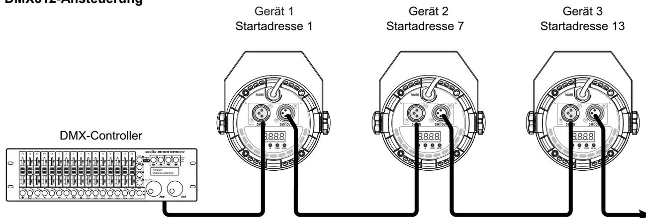
Für die Ansteuerung des Geräts per DMX512 ist eine Datenverbindung notwendig. Das Gerät verfügt dazu über 3-polige XLR-Anschlüsse.
