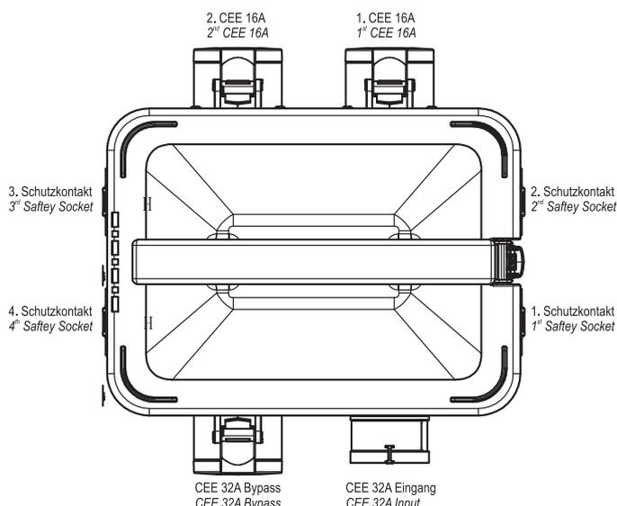
Abb. 1 Aufbau des Stromverteilers SBPO-3240
