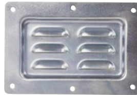
Best.-Nr. 30000197 ROADINGER Einlass-Schale, Lüftung • 1 mm Stahl, verzinkt • Gewicht: ca. 160 g • Ausschnitt: 126 x 74mm • Befestigungslöcher: D=5,1 mm
