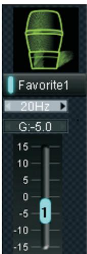
Geben Sie in das Feld „**FC**“ die Filterfrequenz ein oder klicken Sie auf die Pfeile. Die Verstärkung wird im Feld „**Gain**“ oder mit dem Schieberegler eingestellt.
