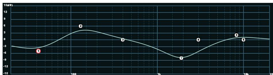
Die Parameter können auch grafisch über die Frequenzkurve eingestellt werden. Zu jedem Filter wird ein Bezugspunkt (weißer Kreis mit roter Markierung) neben der Kurve gezeigt. Durch horizontales Verschieben des Punkts mit der Maus lässt sich die Frequenz ändern, durch vertikales Verschieben die Verstärkung.
