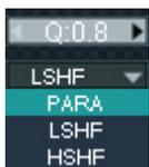
Unter „Type“ stehen drei Filtertypen zur Auswahl: PARA (Grundeinstellung), LSHF (Low Shelving Filter, Tiefenfilter mit Kuhschwanzcharakteristik) und HSHF (High Shelving Filter = Höhenfilter mit Kuhschwanzcharakteristik). Die Güte (Q) und damit die Steilheit des Filters lässt sich im Feld „Q Value“ einstellen.
