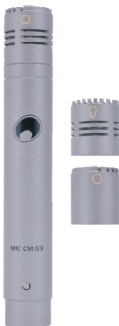
Das MIC CM-53 ist ein äußerst vielseitiges Kondensatormikrofon für Studio- und Live-Anwendungen. Durch seine austauschbare Kapsel kann es mit Nieren-, Supernieren-, oder auch Kugelcharakteristik betrieben werden. Somit ist es äußerst flexibel einsetzbar, als Overhead- oder Instrumentenmikrofon, oder auch für räumliche Aufnahmen. Im Lieferumfang enthalten sind drei Kapseln, ein Mikrofonhalter, Windschutz, Adapter-schraube und eine Transporttasche.
