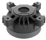
Best.-Nr. 12602710 LAVOCE DF10.10LM 1" Kompressionstreiber, Ferrit 15 W AES, 8 Ohm, 107 dB, 1500-18000 Hz
