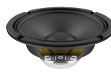
Best.-Nr. 12602610 LAVOCE WSN061.52 6,5" Woofer, Neodym, Stahlkorb 125 W AES, 8 Ohm, 94,5 dB, 90-5000 Hz
