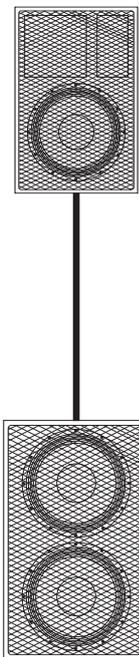
Wird eine Lautsprecherbox mit Einbaufansch auf eine Bassbox montiert, spricht man von einem Satellitensystem.
