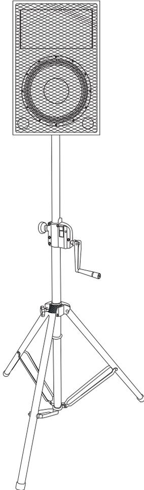
Die Lautsprecherbox darf nur auf ein Stativ bzw. einen Boxenhochständer montiert werden, wenn sie im Lieferzustand über eine entsprechende Aufnahmevorrichtung verfügt.
