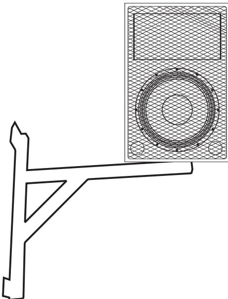
Bei Überkopfmontage muss die Lautsprecherbox immer mit einer Absturzsicherung versehen werden. Bitte beachten Sie die Hinweise unter Absturzsicherung.
