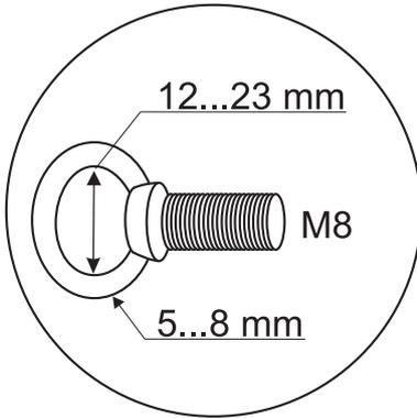
Die Lautsprecherbox muss über eine geeignete Fangseilöse gesichert werden.
