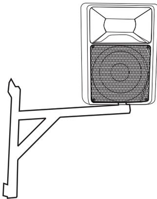
Der Installationsort muss so gewählt werden, dass das Gerät absolut plan an einem festen, erschütterungsfreien, schwingungsfreien und feuerfesten Ort befestigt werden kann. Mittels Wasserwaage muss überprüft werden, dass das Gerät absolut plan befestigt wurde.
