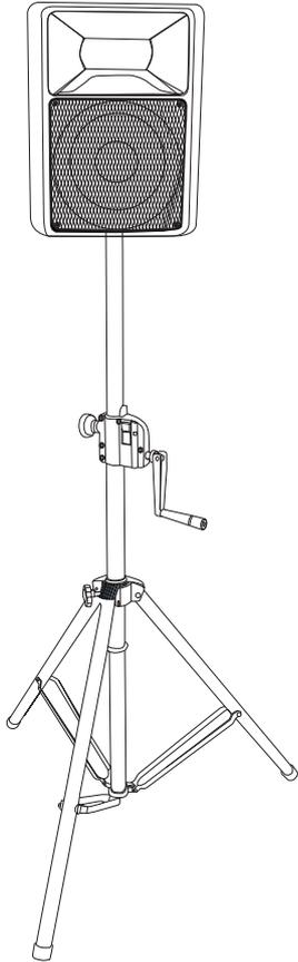
Stative oder Satellitensysteme dürfen nur auf einer ebenen Fläche mit maximal 5° Neigung aufgestellt werden.
