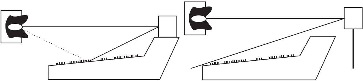
Richten Sie die Monitore nicht frontal aus, sondern drehen Sie die Lautsprecher leicht zum Hörer hin. Um Reflektionen von der Decke oder vom Boden zu vermeiden, sollten sich der Hochtöner auf Ohrhöhe befinden.
