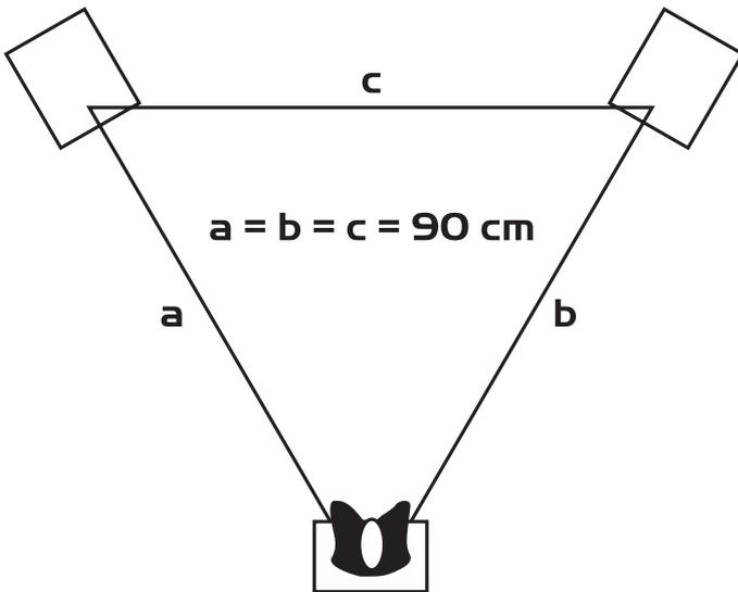
Installieren Sie die Monitore so, dass sich zwischen den beiden Boxen und dem Hörer ein gleichschenkliges Dreieck  $a = b = c$  bildet. Der Abstand zwischen Hörer und Monitor sollte gleich groß sein (ca. 90 cm).
