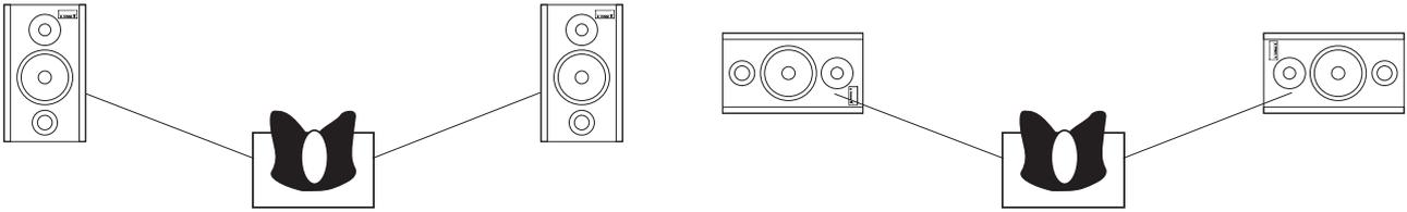
Diese Monitore sind magnetisch abgeschirmt, so dass sie neben Bildschirmen, z. B. am Computer oder Videoschnittplatz betrieben werden können. Bitte halten Sie dennoch einen Mindestabstand von 8 cm zum Bildschirm ein. Wird das Bildsignal eines empfindlichen Gerätes dennoch gestört, vergrößern Sie den Abstand entsprechend.
