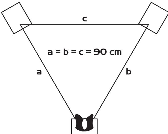
Installieren Sie die Monitore so, dass sich zwischen den beiden Boxen und dem Hörer ein gleichschenkliges Dreieck  $a = b = c$  bildet. Der Abstand zwischen Hörer und Monitor und zwischen den beiden Monitoren sollte gleich groß sein (ca. 90 cm).
