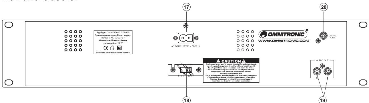
**17. CONEXIÓN AC****18. SELECTOR DE VOLTAJE**
