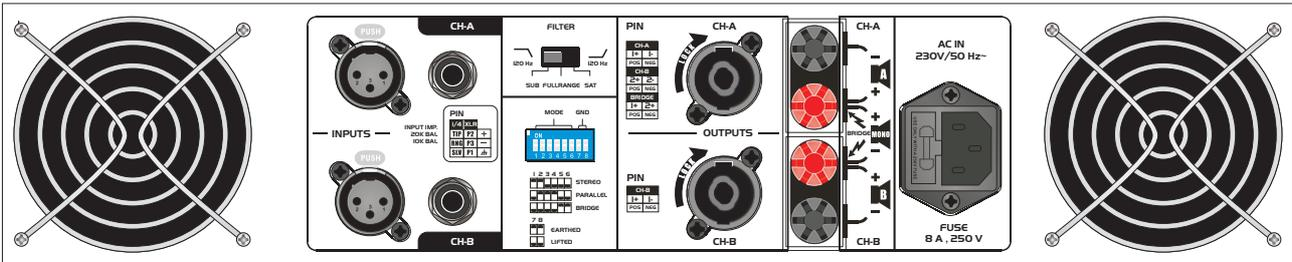
**(8) VENTILATION FAN****(9) PARALLEL/DUAL/BRIDGE MODE SELECTOR**
