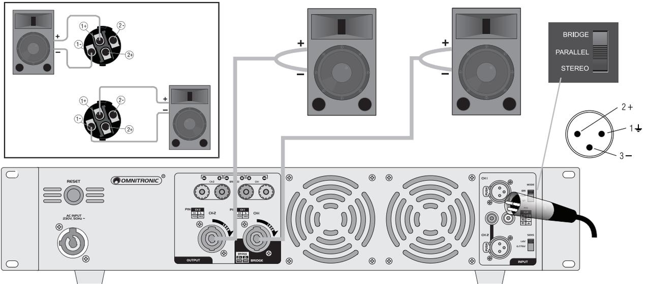
Abb. 3 Verwendung der Speaker-Buchsen im Parallelbetrieb
