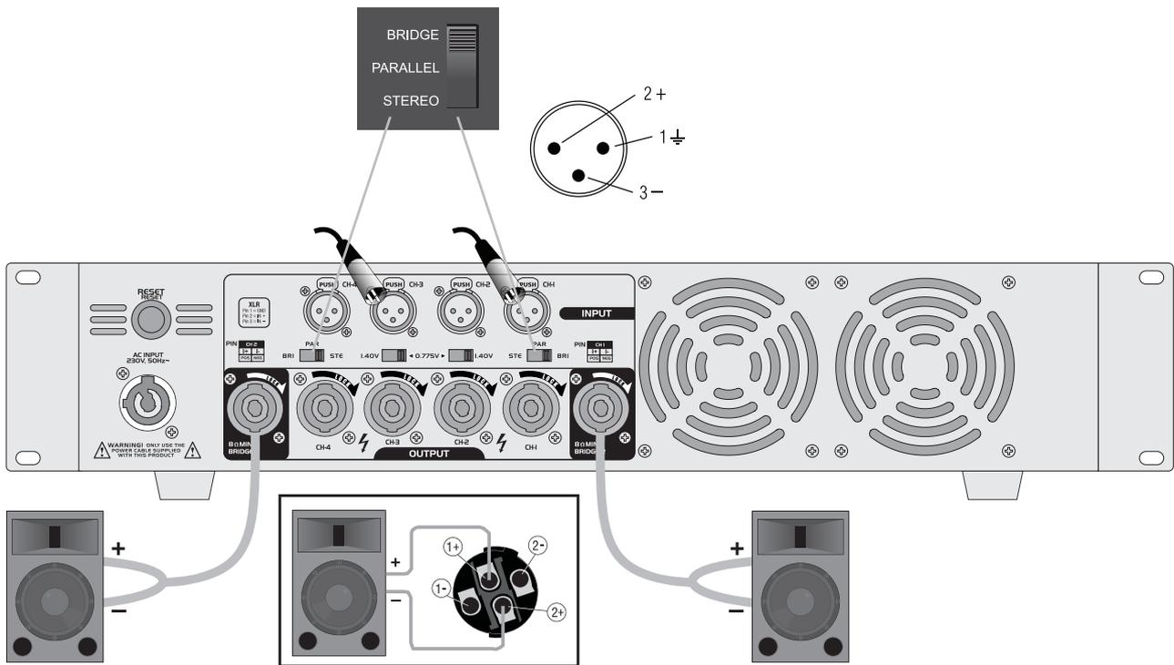
Abb. 9 Verkabelung im Brückenbetrieb
