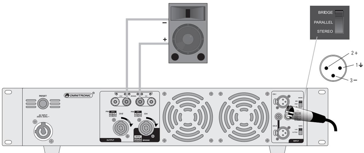
Abb. 6 Verwendung der Schraubklemmen im Brückenbetrieb
