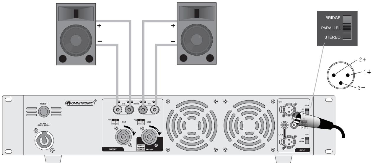
Abb. 4 Verwendung der Schraubklemmen im Parallelbetrieb
