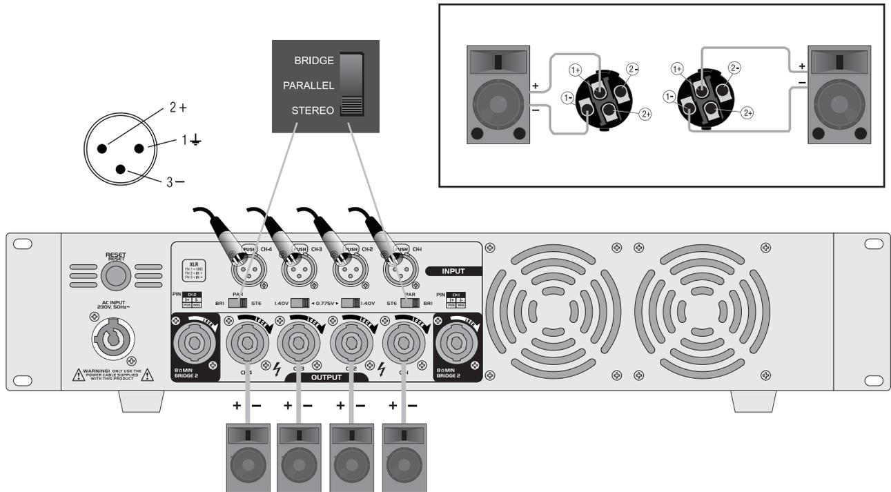
Abb. 7 Verkabelung im Stereobetrieb
