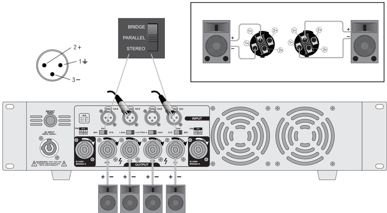
Abb. 8 Verkabelung im Parallelbetrieb
