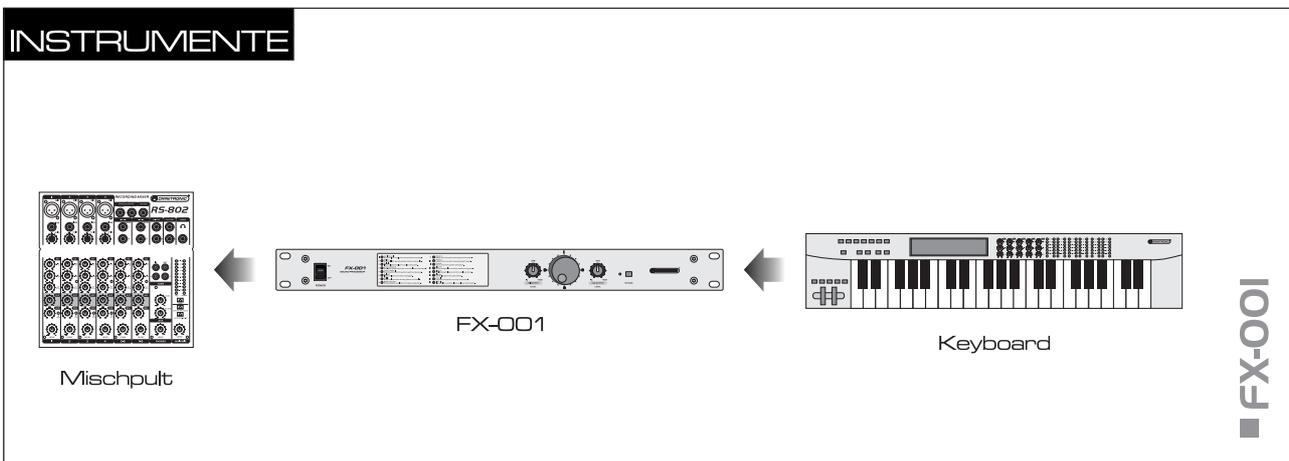
Der FX-001 lässt sich auch zwischen zwei Geräte schalten (z.B. als Effektgerät für Bühneninstrumente).
