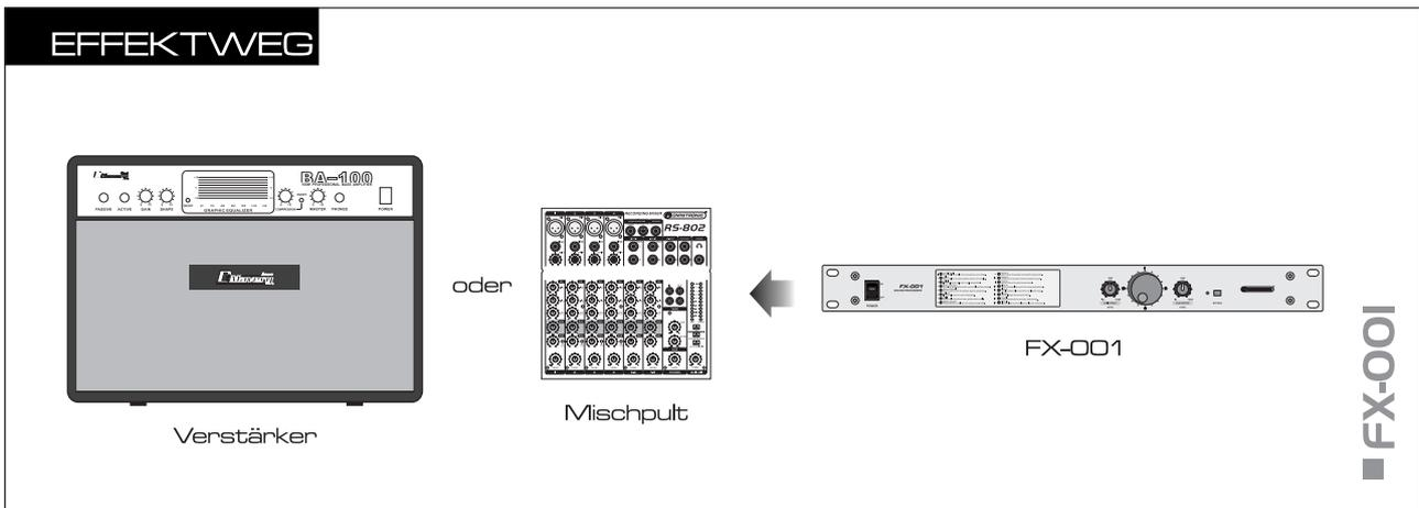
Der FX-001 kann über die Eingänge INPUT und die Ausgänge OUTPUT in die Effektwege eines Mischpults oder Instrumentenverstärkers eingeschleift werden.
